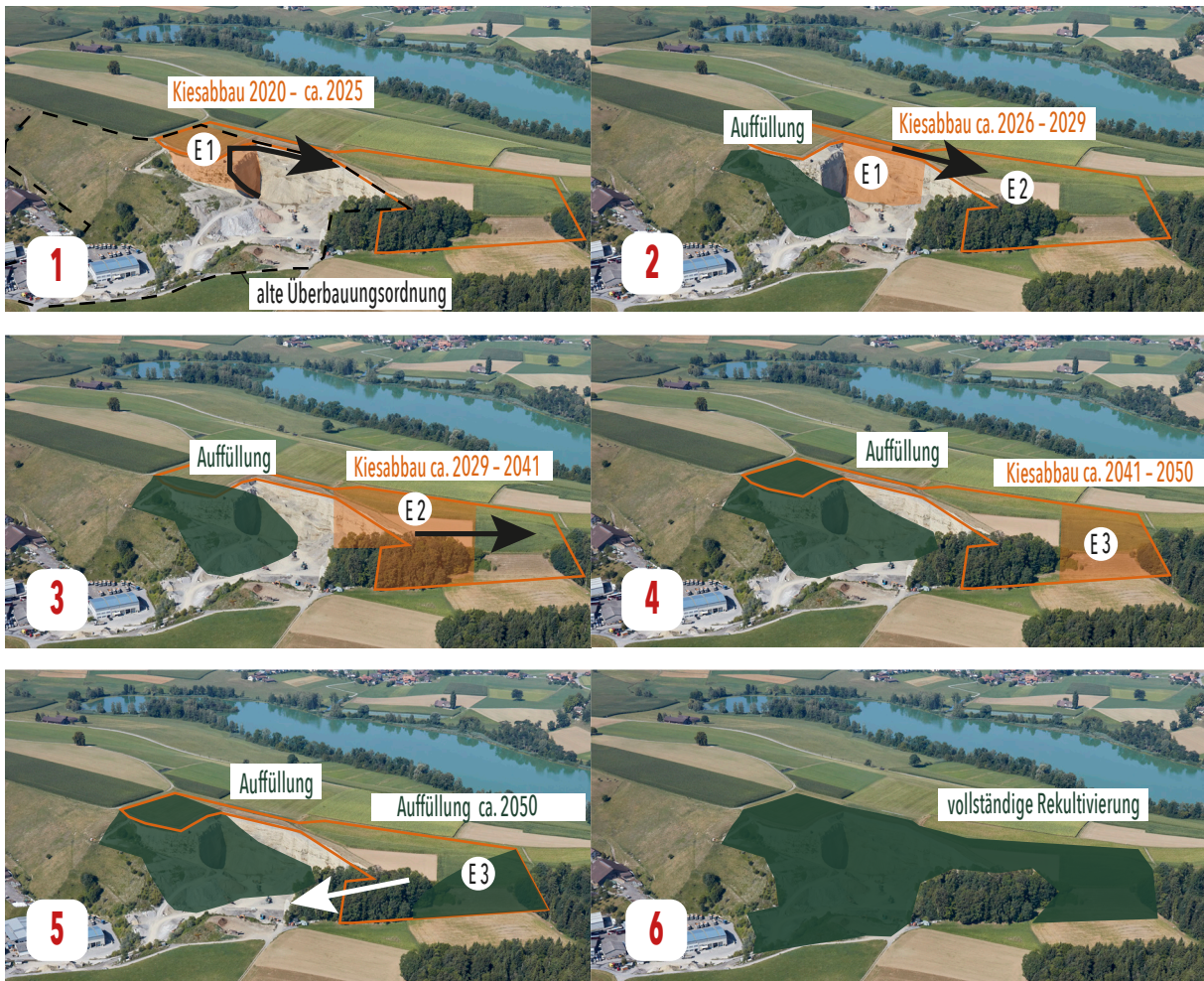
Abb. 4: Ablauf Abbau und Auffüllung (Schrägansicht). Orange Fläche = Kiesabbau, dunkelgrüne Fläche = Auffüllung, schwarzer Pfeil = Abbaurichtung, weisser Pfeil = Auffüllrichtung.
